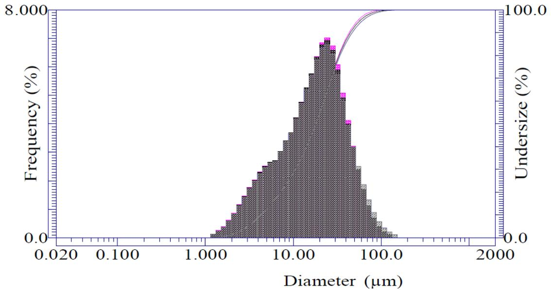
Fig. 3(b) Particle Size Distribution of "DS325" Pumice
